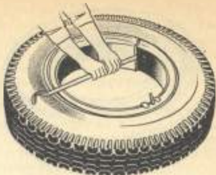
Рис. 147. Демонтаж обода колеса
